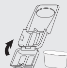
Filtro de carbón para el dispensador de agua caliente
